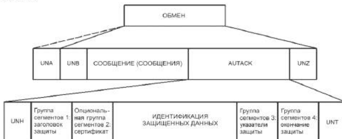
Рисунок 1 – Схема обмена, использующего защиту с помощью сообщения AUTACK на уровне сообщений
