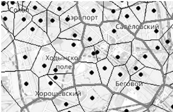
Рисунок 3 — Пример зоны действия соседних управляющих контроллеров, состоящих из зон действия базовых станций, подчиненных одному управляющему контроллеру
