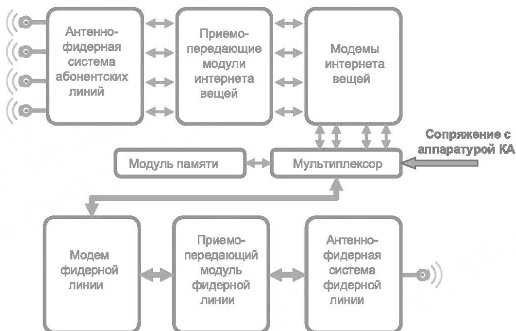
Рисунок 4 — Типовая архитектура полезной нагрузки космического аппарата
