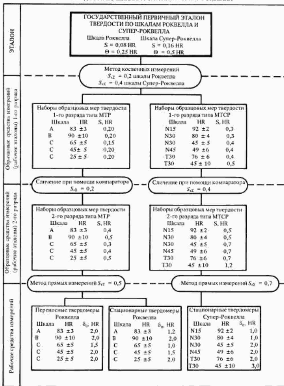
$S_{\text{el}}$  - среднее квадратическое отклонение результата измерений
