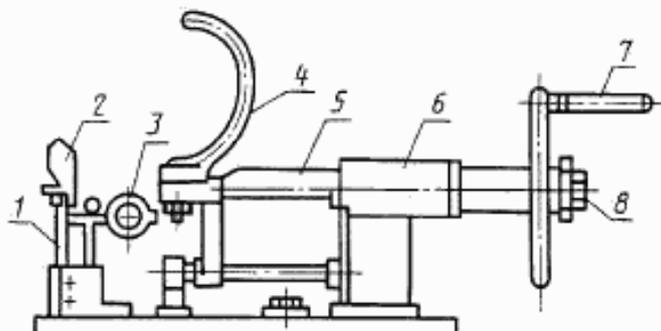
1 — силовизмерительная пружина; 2 — передний держатель; 3 — индикатор часового типа; 4 — задний держатель; 5 — подвижной шток; 6 — подшипник; 7 — ручной привод; 8 — ограничительная пробка
