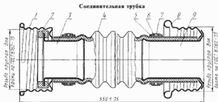
1 — гайка накидная; 2 — кольцо непьющее (по рабочим чертежам); 3 — nipple 1; 4 — трубка резиновая гофрированная ТРГ-2 или ТРГ-4 по нормативной документации; 5, 7 — лента изоляционная (по рабочим чертежам); 6 — проволока стальная низкоуглеродистая общего назначения по ГОСТ 3282—74; 8 — прижим винтовой; 9 — патрубок
