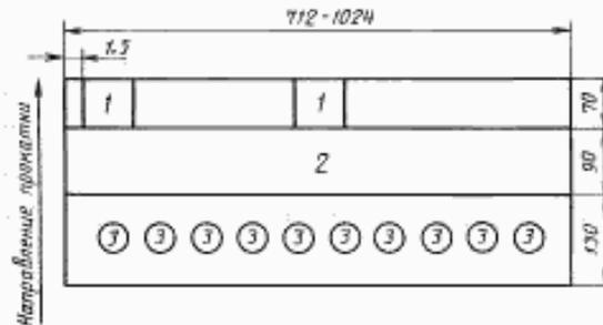
1 — образцы для измерения твердости (70×70 мм); 2 — полоса шириной 90 мм для испытания на выдавливание лунки по Эриксену; 3 — образцы для определения массы оловянного покрытия (∅ 20 мм)
