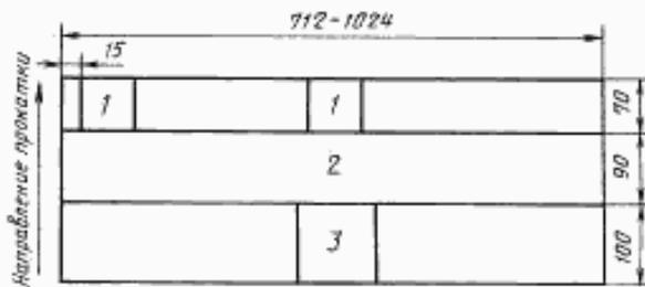
1 — образцы для измерения твердости (70×70 мм);
