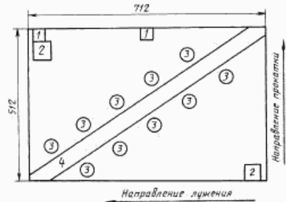
1 — образцы для измерения твердости (70×70 мм); 2 — образцы для измерения оловянного покрытия (100×100 мм); 3 — образцы для определения массы оловянного покрытия (∅ 20 мм); 4 — полоса шириной 90 мм по диагонали листа для испытания на выдавливание лунки по Эриксену
