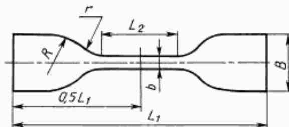
Рисунок 2 — Образец-лопатка типа 2
