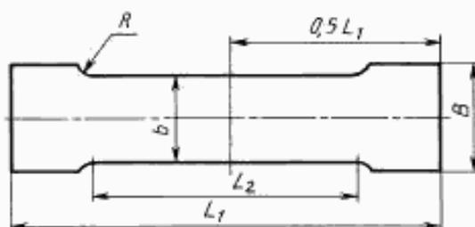
Рисунок 1 — Образец-лопатка типа 1
