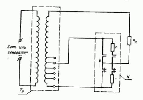
$R_{\rm st}$  — кагрузочный резистор;  $\Gamma_{\rm p}$  — всамтательный трансформатор или автотрансформатор; K — контактор (переключатель нагрузки) с токоограничивающим резистором.
