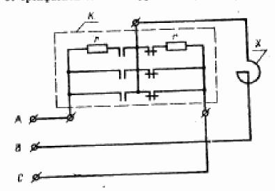
X — нагрузочный реактор; К — контактор (переключетель нагрузки) с токоограничивающими резисторами Черт. 5 Скема для испытаний на электрическую износостойкость двух контакторов при пониженном напряжении с применением нагрузочного резистора
