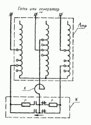
Апр — испытательный автограноформатор или траноформатор; X — нагрузочный ревитор; K — компантор (переключатель нагрузки) с токоограничнаяющими реакторами.
