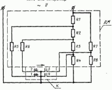
ДМ — делитель мощности на резисторих; К — контактор (переключатель нагрузьи).
