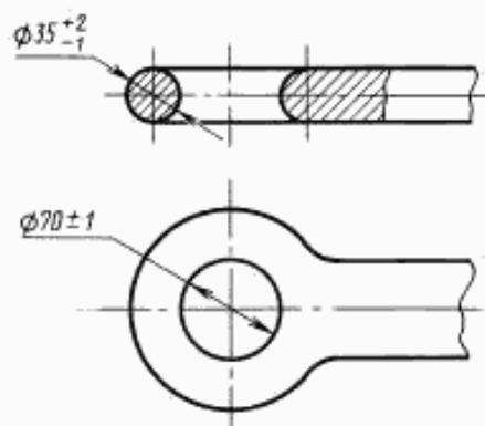
Крепление петли к прицепу и полуприцепу должно быть разъемным.
