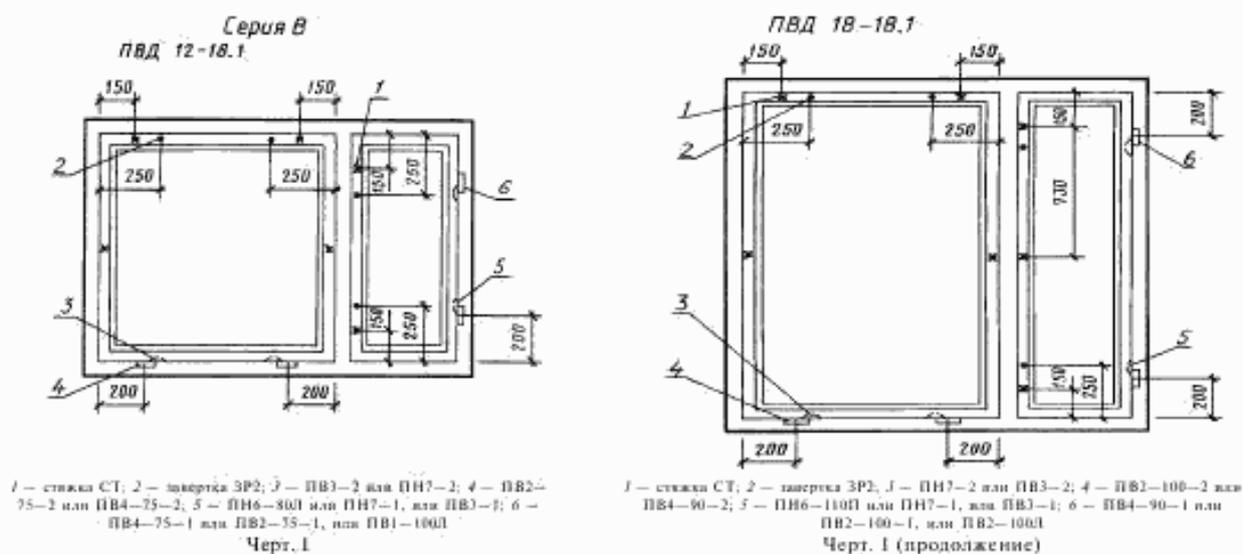
Примечание. В окнах ПВД12-18.1; ПВД18-18.1; ПНД12-18.1; ПНД18-18.1 завертки устанавливают только при отсутствии механизмов открываний.
