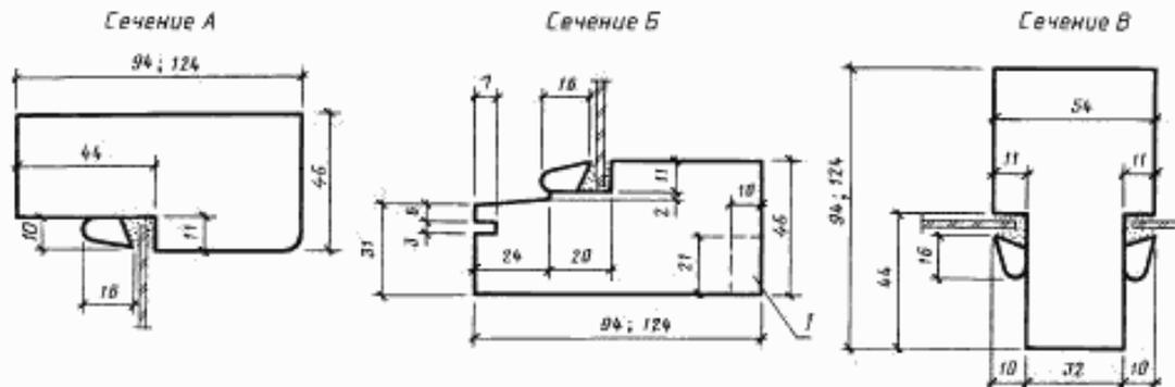
2.7. Уплотнение притворов окон должно производиться прокладками по ГОСТ 10174; места их крепления указаны на чертежах сечений деталей.
