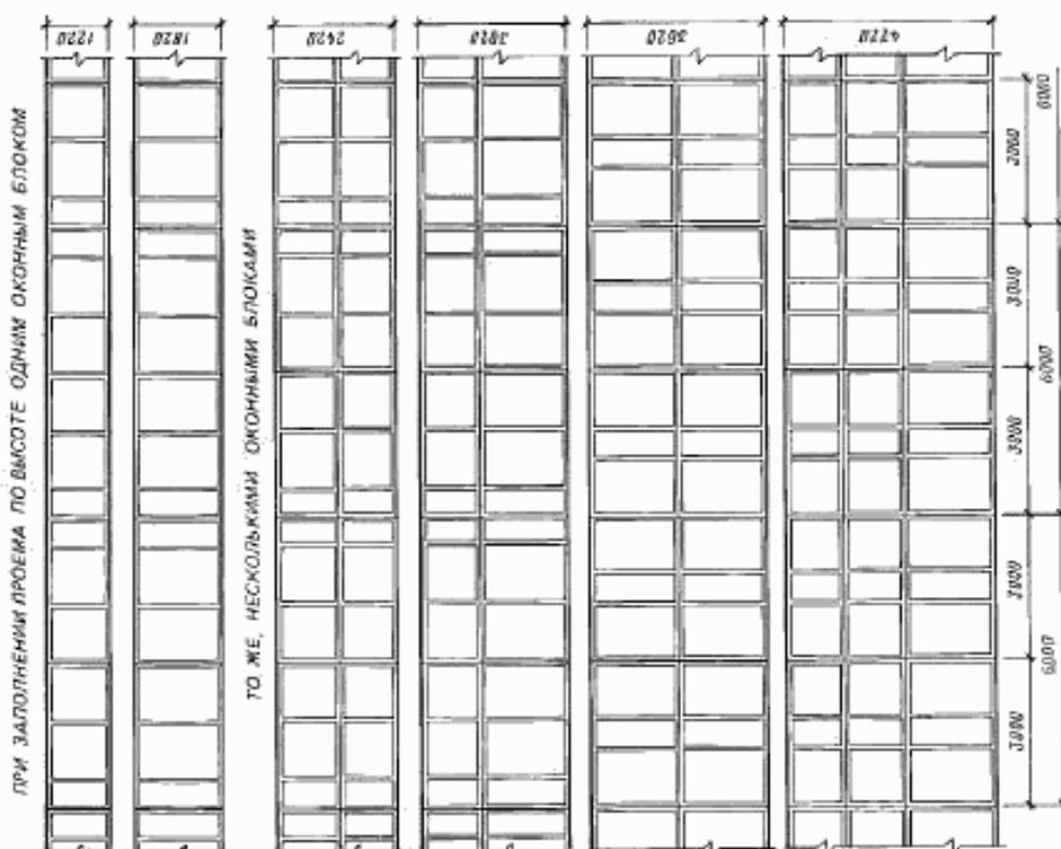
**ПРИМЕРНЫЕ СХЕМЫ ЗАПОЛНЕНИЯ ОКОННЫХ ПРОЕМОВ
