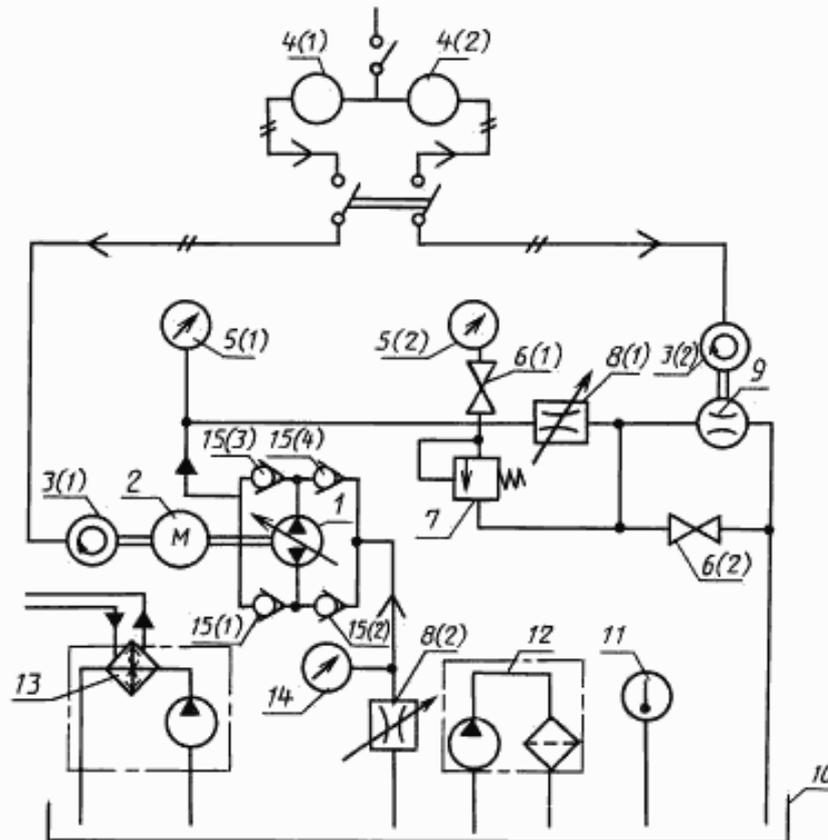
1 — испытуемый насос; 2 — мотор-весы; 3 — преобразователь частоты вращения;
