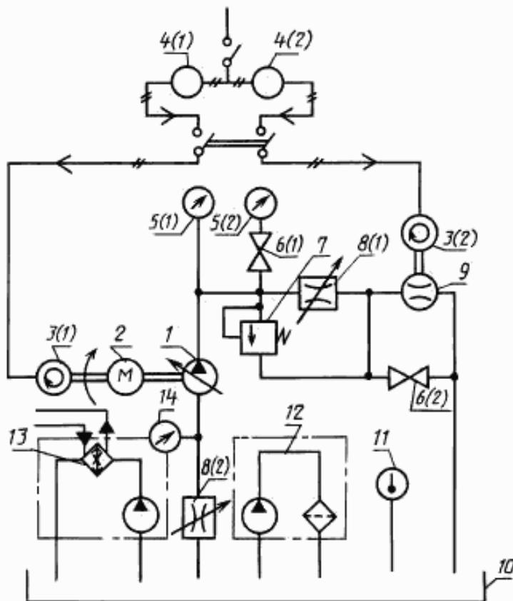
1 — испытуемый насос; 2 — мотор-весы; 3 — преобразователь частоты вращения;
