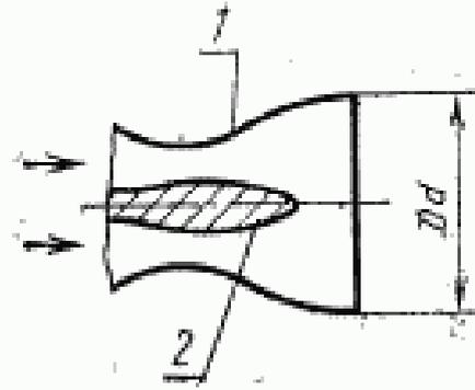
1 — внешний участок контура; 2 — внутренний участок контура
