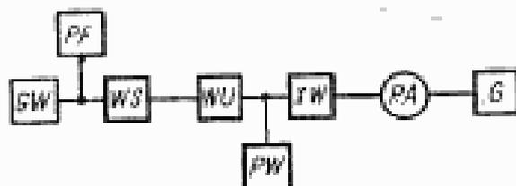
GW—генератор СВЧ сигнала; PF—частотомер; WS—ферритовый вентиль; WU—переменный аттенуатор; PW—измеритель мощности; XW—измерительная диодная камера; G—источник тока смещения; PA—микроамперметр.
