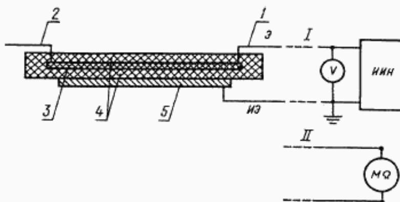
1, 2 — выводы; 3 — неметаллический нагревательный элемент; 4 — изоляция; 5 — внешний электрод; Э — электрод для подачи напряжения; ИЭ — измерительный электрод; ИИИ — источник испытательного напряжения; I — подключение при проверке электрической прочности изоляции; II — подключение при проверке сопротивления изоляции
