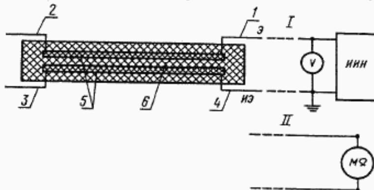
1, 2, 3, 4 — выводы; 5 — неметаллические нагревательные элементы; 6 — межслойная изоляция; Э — электрод для подачи напряжения; ИЭ — измерительный электрод; ИИН — источник испытательного напряжения; I — подключение при проверке электрической прочности изоляции; II — подключение при проверке сопротивления изоляции
