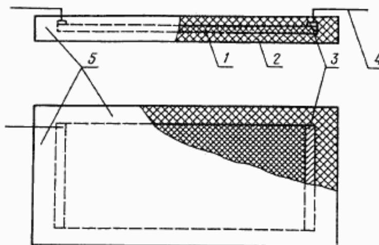
1 — неметаллический нагревательный элемент; 2 — электрическая изоляция;
