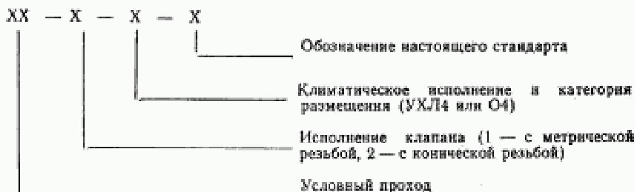
Пример условного обозначения клапана с условным проходом 10 мм с метрической резьбой, климатического исполнения УХЛ категории размещения 4:
