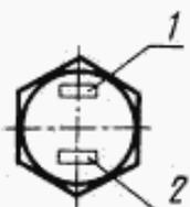
1 — клеймо предприятия-изготовителя; временное сопротивление болта, МПа, деленное на 10; знак исполнения «ХЛ», 2 — условное обозначение номера плавки
