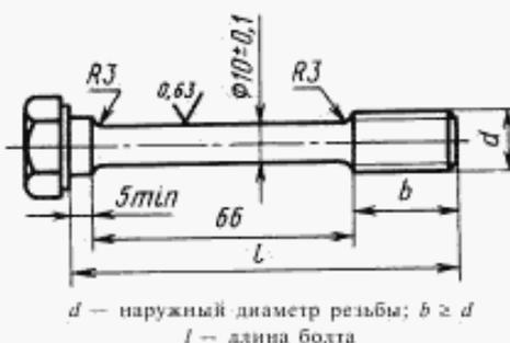
$d$  — наружный диаметр резьбы;  $b \geq d$
