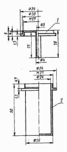
/--павинчивающаяся крышка о гильной для термопары; 2--циливдрический стакаи.
