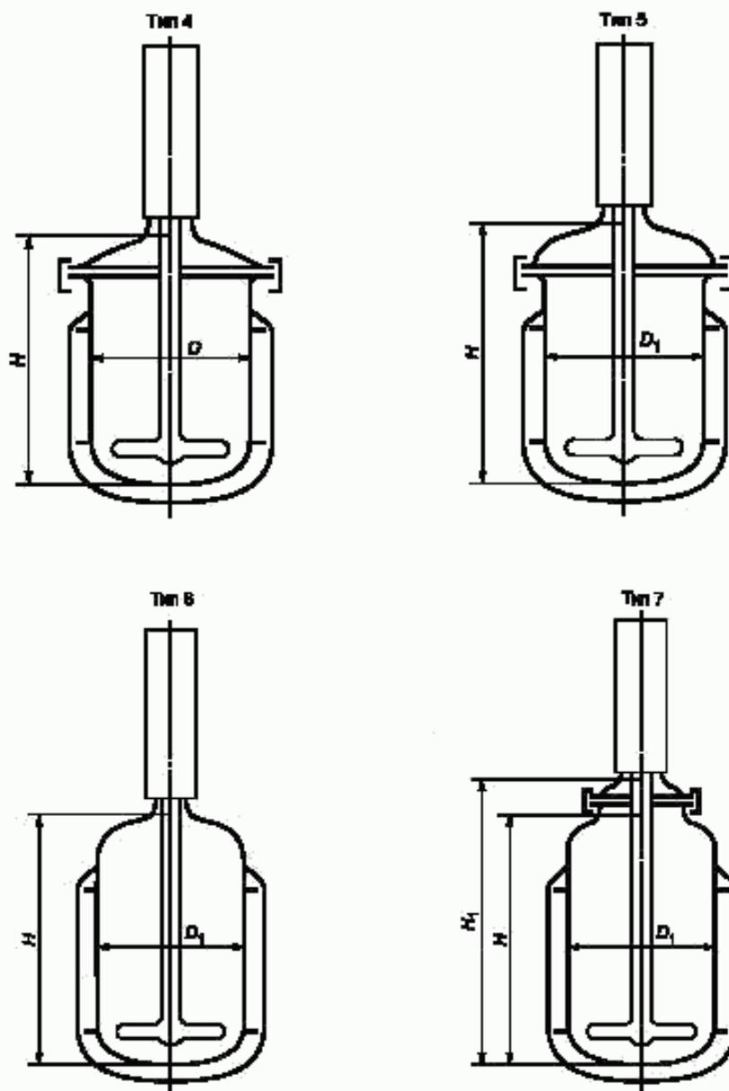
$D$  — внутренний диаметр аппарата;  $D_1$  — наружный диаметр аппарата
