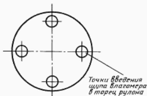
3.3.3.3. При определении влажности льнотресты в снопах щуп влагомера вводят в середину боковой стороны каждого снопа пробы до момента загорания сигнальной лампочки, после чего фиксируют показания прибора.
