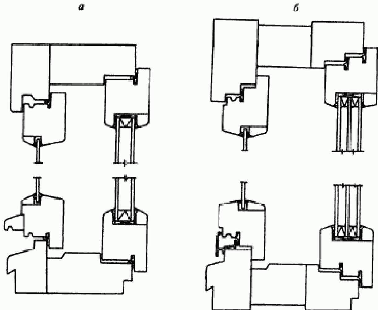
*a* — вариант конструкции с остеклением «стекло + однокамерный стеклопакет» с двумя контурами прокладок в наружной и внутренней створках с деревянным отливом; *b* — вариант конструкции с остеклением «стекло + двухкамерный стеклопакет» с тремя контурами прокладок в наружной и внутренней створках с алюминиевым дождезащитным профилем (отливом).
