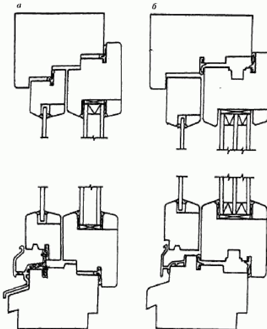
*а* — вариант конструкции с распашным открыванием створок; внутренняя створка остеклена однокамерным стеклопакетом; с двумя контурами прокладок в наружной и внутренней створках; с алюминиевым дождезащитным профилем с термовставкой; *б* — вариант конструкции с поворотно-откидным открыванием створок; внутренняя створка остеклена двухкамерным стеклопакетом; с двумя контурами прокладок во внутренней створке и коробке с алюминиевым дождезащитным профилем
