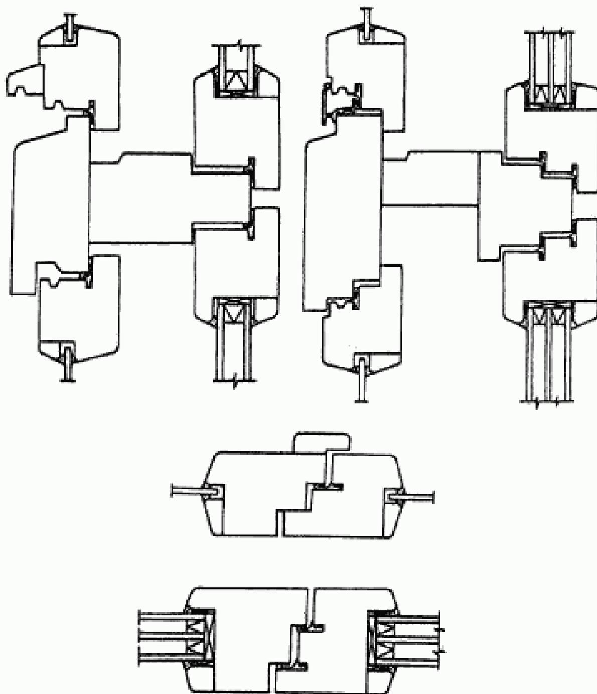
**Рисунок 6** — Примеры конструктивных решений impostных и безimpostных притворов оконных блоков раздельной конструкции
