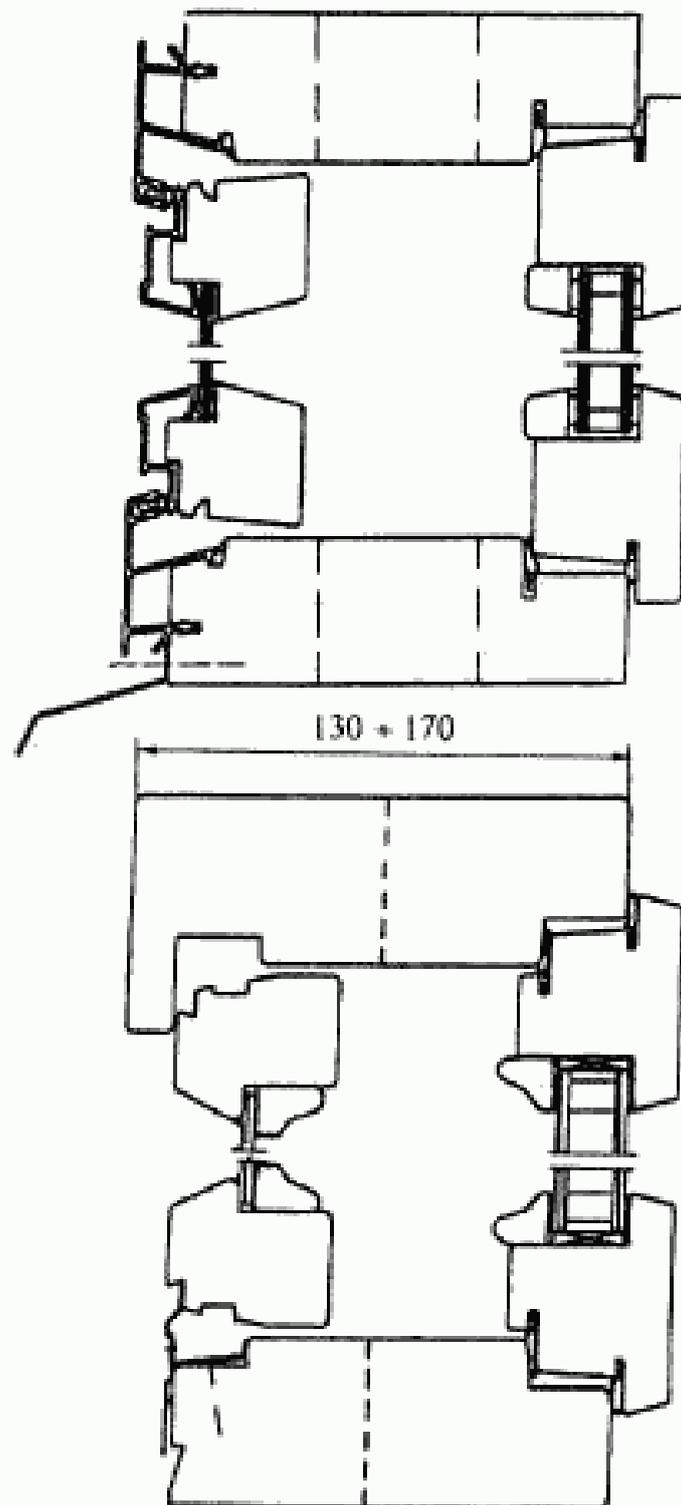
**Рисунок 7** — Примеры конструктивных решений оконных блоков раздельной конструкции с безнаплавной наружной створкой (основной и нижней притворы)
