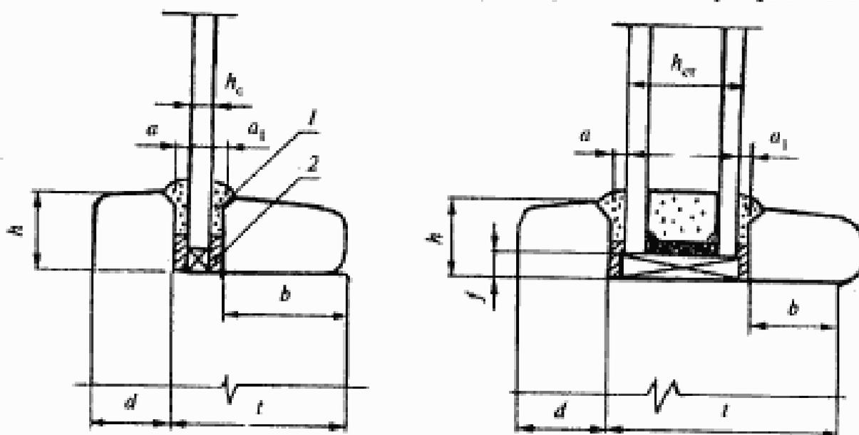
$t$  — размер основания фальца (четверти под остекление);  $d$ ,  $h$  — размеры боковой щечки опоры остекления;  $a$ ,  $a_1$  — толщина внутренних слоев герметика;  $b$  — размер опоры для крепления штапика;  $h_c$  ( $h_{ст}$ ) — толщина стекла (стеклопакета);  $f$  — зазор между стеклопакетом и основанием фальца
