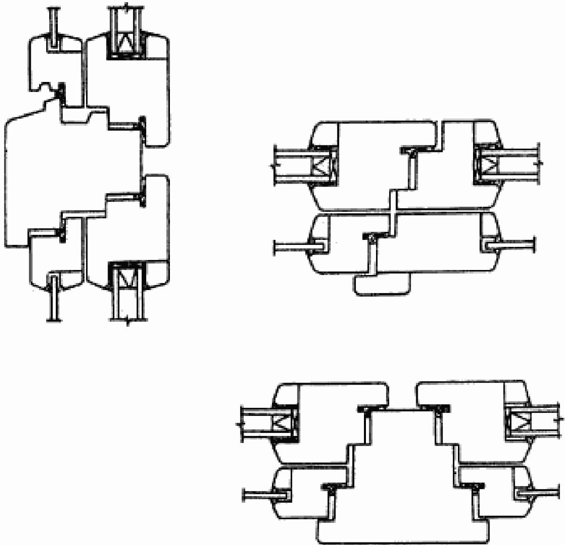
**Рисунок 3** — Примеры конструктивных решений импостных и безимпостных притворов оконных блоков сларенной конструкции (вариант распашного открывания)
