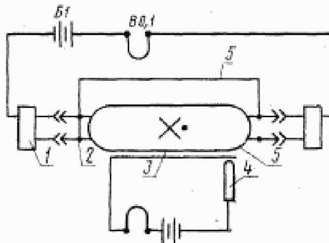
1—патрон испытуемого прибора; 2—перемычка между штырями цоколя лампы; 3—полоска стали, наклеенная на лампу; 4—бойк; 5—люминесцентная лампа; 6—перемычка между электродами;  $BO_1$ ,  $BO_2$ —вибраторы осциллографа;  $B_1$ ,  $B_2$ —батареи питания цепей вибраторов осциллографа
