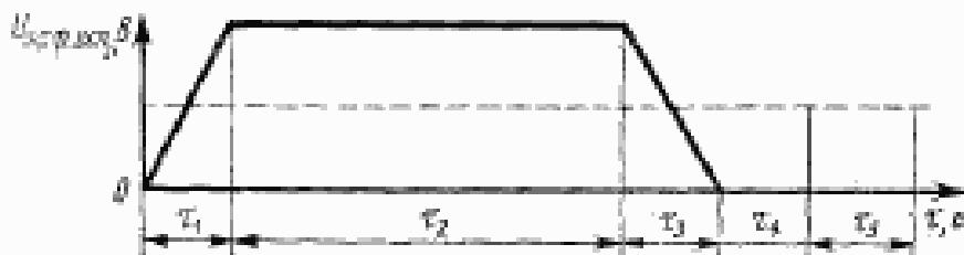
— — — переменное напряжение; — — — постоянное напряжение;  $t_1$  — время подачи переменного напряжения 0,2—0,5 с;  $t_2$  — время выдержки под суммарным испытательным напряжением ( $\pm 2$ ) с;  $t_3$  — время снятия переменного напряжения 0,2—0,5 с;  $t_4$  — время выдержки под напряжением постоянного тока до момента контроля сопротивления изоляции ( $\pm 0,2$ ) с;  $t_5$  — время контроля сопротивления изоляционного промежутка.
