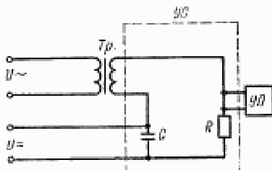
*У<sub>~</sub>—источник переменного напряжения; У<sub>π</sub>—источник постоянного напряжения; Т<sub>р</sub>—высоковольтный трансформатор; R—ограничительный резистор; C—разделятельная ѹмкость, 1—6 мкФ; УС—устройство смещения постоянной и переменной составляющих; УП—устройство для подключения испытуемого объекта*
