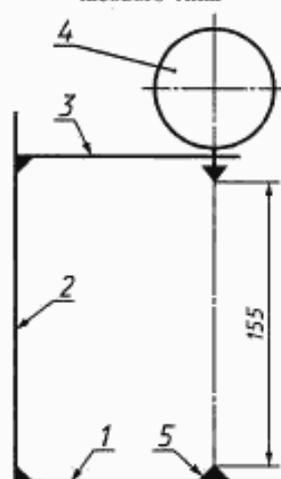
1 — основание; 2 — стойка; 3 — кронштейн; 4 — индикатор; 5 — шаровая опора
