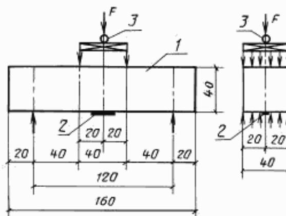
$F$  — опытный образец; 2 — тензорезистор с базой 20 мм; 3 — электрический силоизмеритель
