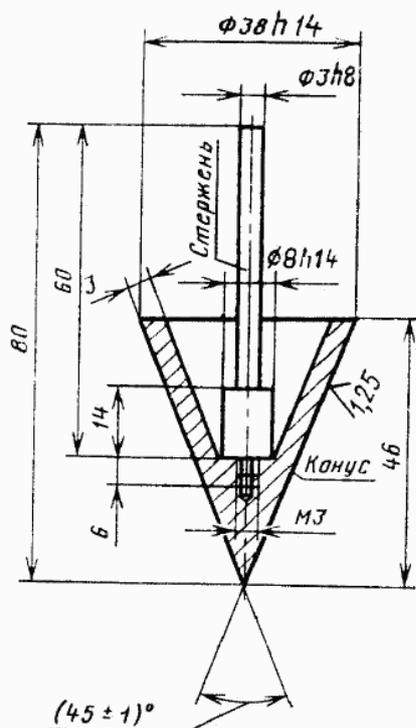
Неуказанные предельные отклонения остальных размеров  $\pm \frac{t_2}{2}$ .
