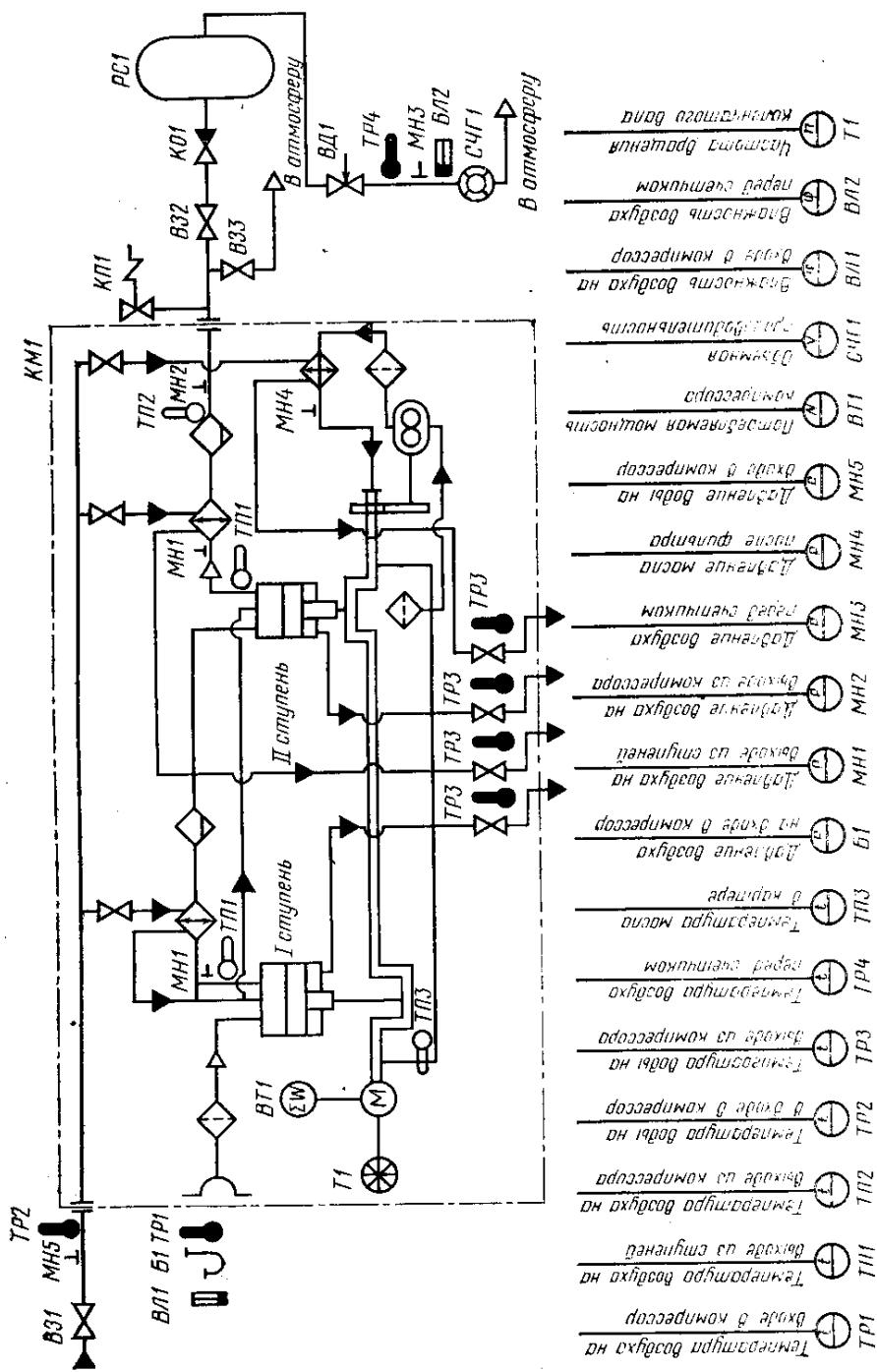
*B1*—барометр; *B7I*—ваттметр; *B1I*, *B12*, *B13*—влагомеры; *BДI*—дросселирующий вентиль; *B3I*—*B33*—запорные вентили; *KM1*—компрессор; *KП1*—предохранительный клапан; *KO1*—обратный клапан; *MН1*—*MН5*—манометры; *PC1*—рецивер; *CЧГ1*—счетчик газа; *T1*—тахометр; *TP1*—*TP4*—рутные термометры; *ТП1*—*ТП3*—термопары
