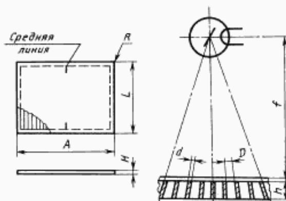
$A$  — размер поперек полос раstra;  $L$  — размер вдоль полос раstra;  $H$  — высота раstra (с обрамлением);
