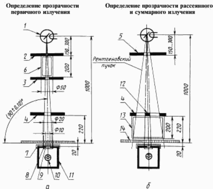
1 — рентгеновская трубка; 2, 3, 4, 5 — свинцовые диафрагмы; 6 — цилиндрический фантом; 7 — алюминиевый фильтр;
