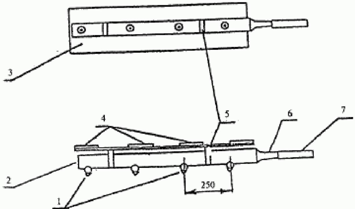
1 — форсунки; 2 — металлическая трубка; 3 — пластина для крепления трубки с форсунками; 4 — магнитные накладки для крепления элемента к стенке камеры;
