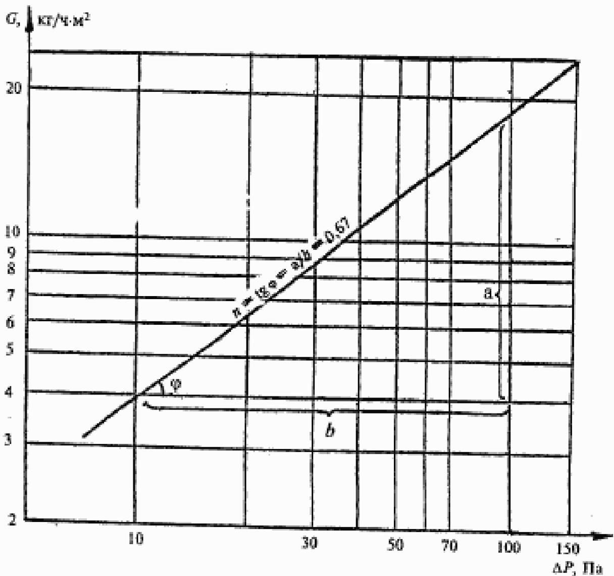
**Рисунок 3** — Пример построения диаграммы зависимости массовой воздухопроницаемости  $G$  от перепада давления  $\Delta P$
