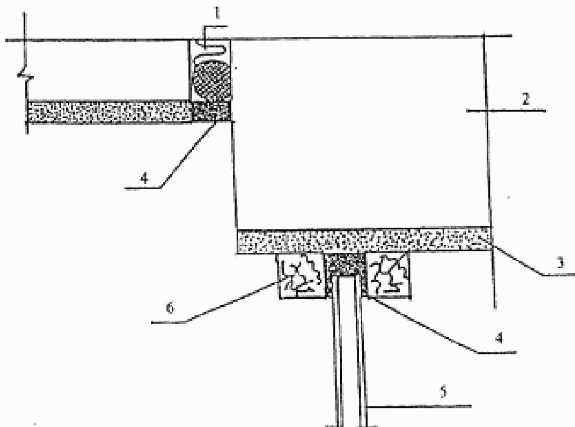
1 — эластичный уплотняющий материал; 2 — проем стены; 3 — штукатурный слой; 4 — специальная замазка (герметик) или эластичная прокладка; 5 — стеклопакет (фрагмент светопрозрачной конструкции); 6 — деревянный брусок
