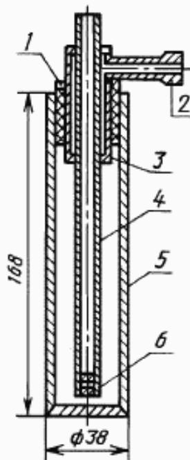
1 — пробка; 2 — трубка для резиновой груши; 3 — корпус трубки для фильтрата; 4 — трубки для фильтрата; 5 — стальной цилиндр; 6 — гнездо для фильтровальной ваты
