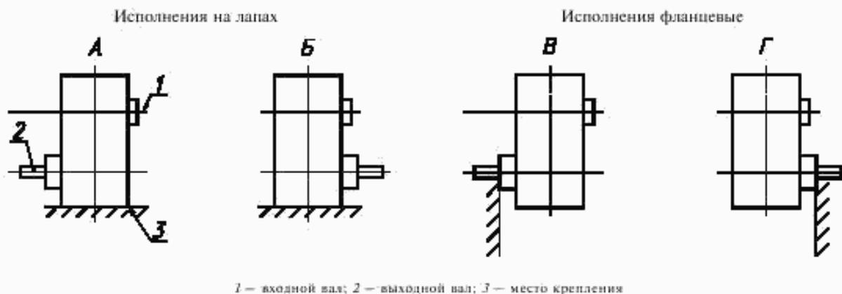
1 — входной вал; 2 — выходной вал; 3 — место крепления
