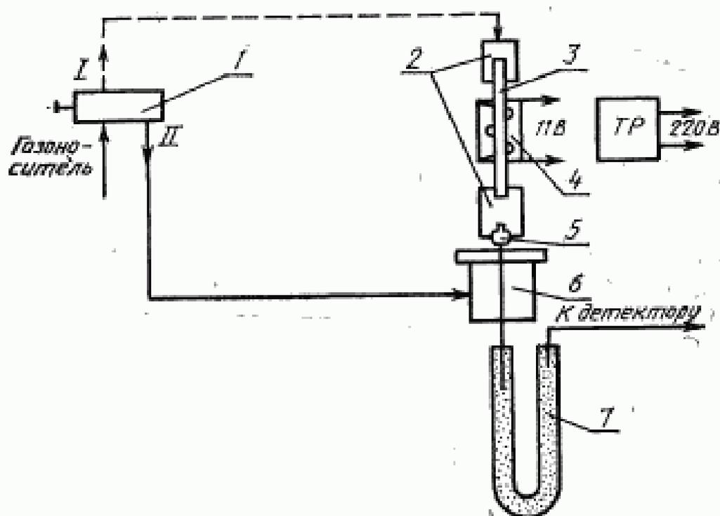
1 — кран-дозатор; 2 — соединительная силиконовая трубка; 3 — концентратор; 4 — термокамера; 5 — инъекционная игла; 6 — испаритель; 7 — хроматографическая колонка
