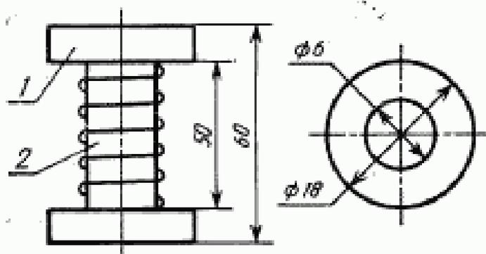
1 — корпус; 2 — нагревательный элемент
