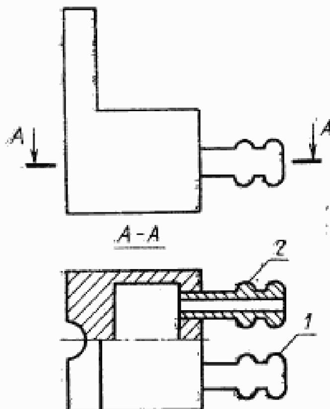
1 — штуцер для входа охлаждающей воды; 2 — штуцер для выхода охлаждающей воды.
