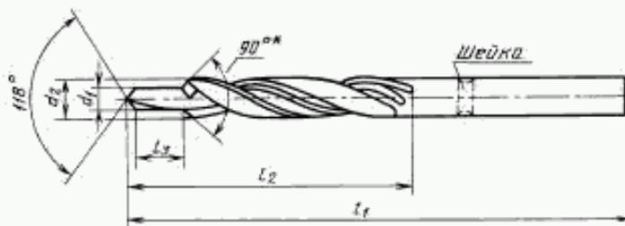
\* Допускается изготовление сверл с углом 120°.
