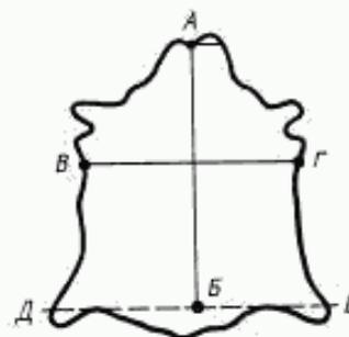
*A, B* — конечные точки линии при измерении длины овчины по хребту; *B, C* — конечные точки линии при измерении ширины овчины; *D, E* — касательная линия к нижним впадинам задних лап, определяющая основание курдюка
