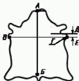
*A, B* — конечные точки линии при измерении длины по хребту; *B, C* — конечные точки линии при измерении ширины овчины; *D, E* — расстояние (3—4 см) ниже нижнего края нижних впадин передних лап
