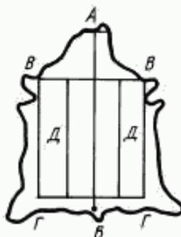
А, Б — линия хребта; В, Г — линии, определяющие границы пол;
