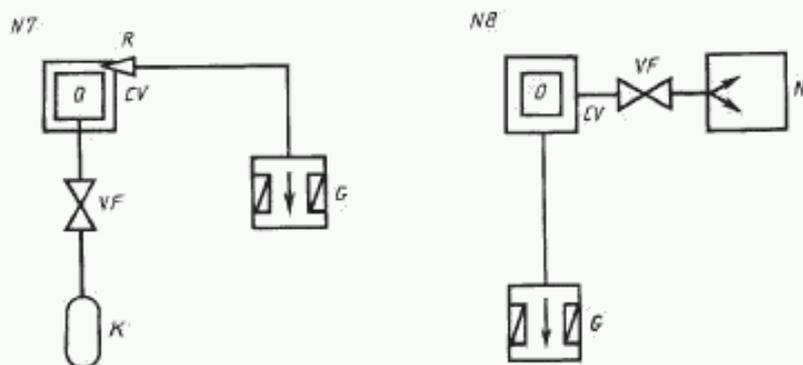
Пояснения к схемам 1—8: *O* — испытуемый объект; *G* — течеискатель; *R* — сопло; *VF* — клапан регулировочный; *N* — насос; *K* — баллон с пробным газом; *D* — обдуватель; *C* — камера, наполненная пробным газом; *CV* — вакуумная камера
