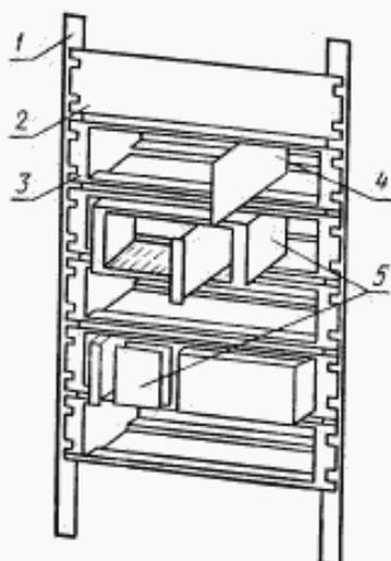
1 — стойка вертикальная; 2 — панель; 3 — блочный каркас;
