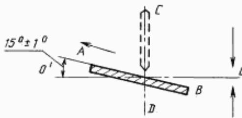
OO' — оптическая ось спектрографа; AB — плоскость каретки с нижним электродом; CD — ось верхнего электрода
