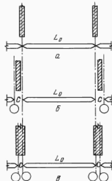
*a* — непрерывная система с совмещением координационных осей с осями несущих стен; *b* — прерывная система с парными координационными осями и вставками между ними; *в* — прерывная система при парных координационных осях, проходящих в пределах толщины стен
