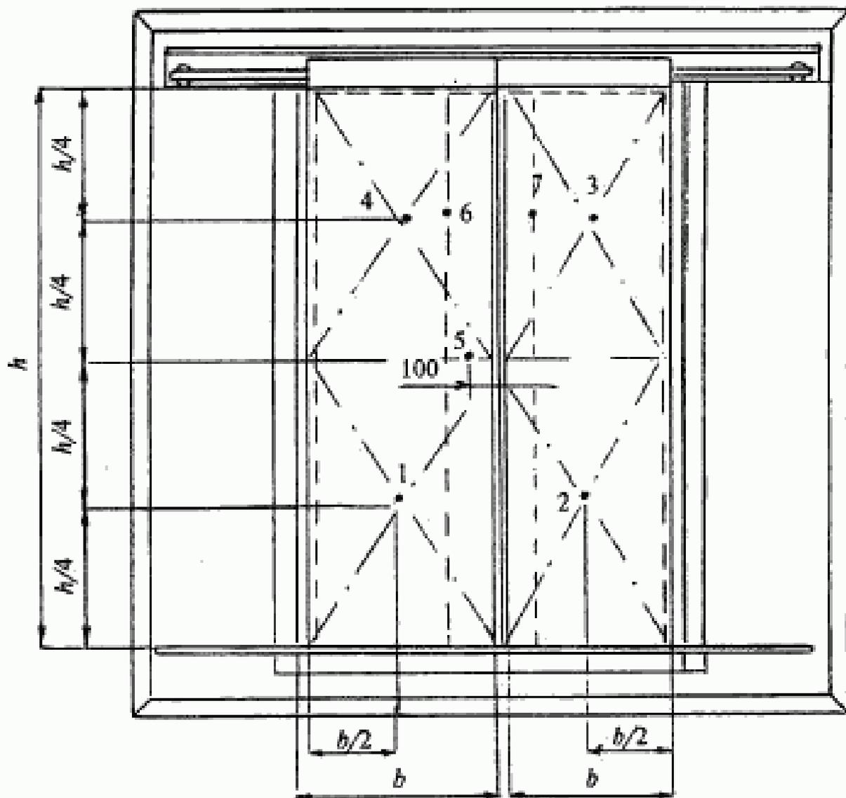
**Рисунок АГ** — Схема установки термоэлектрических преобразователей (термопар) на необогреваемой поверхности двери шахты лифта
