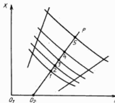
**Рисунок И.1** — Экспериментальный массив  $x = f(n)$  с границами области стабильности определения теплопроводности и характеристическая прямая  $p$  для графического определения теплопроводности материала.
