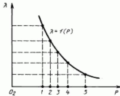
Рисунок И.2 — Зависимость значений теплопроводности от длины отрезка, отсекаемого на характеристической линии  $\rho$  экспериментальной кривой  $\lambda = f(\rho)$
