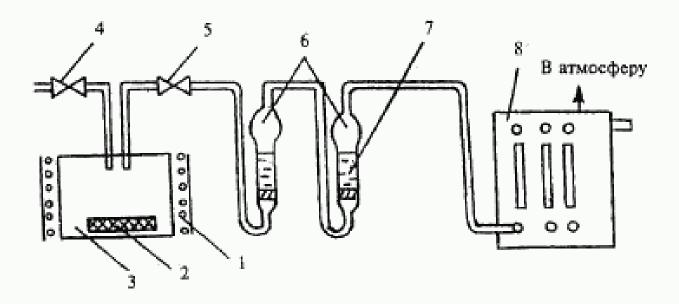
I — воздушный термостат; 2 — образец теплоизоляционного изделия; 3 — гермстичная испытательная камера; 4, 5 — вакуумные краны;  $\delta$  — поглотительные сосуды; 7 — поглотительная жидкость; 8 — аспиратор
