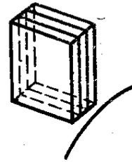
1.51. Щетка цельная из двух материалов — щетка электрической машины, изготовленная из слоев двух материалов
