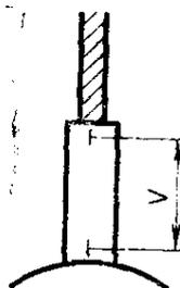
4.8. Падение напряжения в месте крепления токоведущего провода
