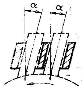
2.11. Наклонный щеткодержатель «тандем» для обоих направлений вращения
