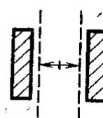
2.46. Торцовое положение щетки в обойме щеткодержателя — положение щетки в обойме щеткодержателя, при котором щетка прижата к одной из стенок обоймы
