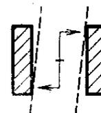
2.48. Фиксированное положение щетки в обойме щеткодержателя — положение щетки в обойме щеткодержателя, при котором щетка жестко закреплена
