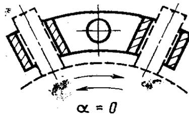
2.16. **Радиальный цилиндрический щеткодержатель** — щеткодержатель, выполненный в виде цилиндра, в котором размещается щетка и нажимная пружина
