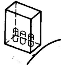
1.54. Накладка щетки — элемент арматуры щетки электрической машины, защищающий верхнюю поверхность щетки от механических повреждений, изолирующий и амортизирующий ее, а также равномерно распределяющий давление на щетку
