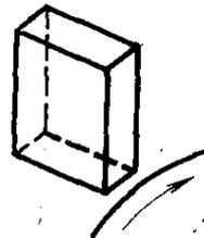
**1.18. Контактная поверхность щетки** — поверхность щетки электрической машины, непосредственно соприкасающаяся с поверхностью коллектора или контактного кольца
