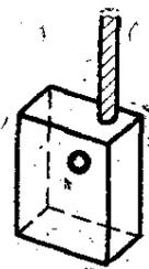
1.65. Крепление токоведущего провода в тело щетки способом конопатки
