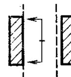
2.47. Диагональное положение щетки в обойме щеткодержателя — положение щетки в обойме щеткодержателя, при котором щетка упирается в нижнюю кромку одной из стенок обоймы и в верхнюю кромку противоположной стенки обоймы щеткодержателя
