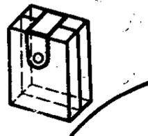
1.50. Многослойная неразрезная щетка — щетка электрической машины, изготовленная из слоев двух или более материалов
