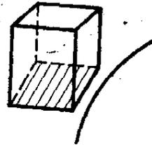
**1.20. Закругленная контактная поверхность щетки**
