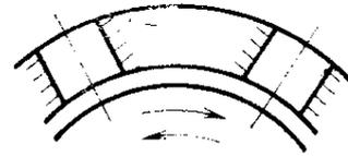
2.28. Щеткодержатель однообоймный с обоймой типа А
