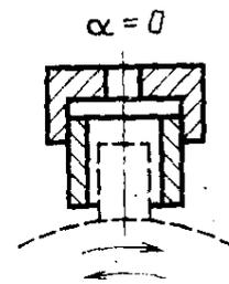
2.17. **Подвижный щеткодержатель** — щеткодержатель, обойма которого с установленной в ней щеткой шарнирно соединена с элементом крепления
