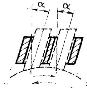
2.12. Щеткодержатель «V—тандем» — щеткодержатель, оси обоем которого в тангенциальном направлении наклонны под углом  $\alpha_1$  и  $\alpha_2$
