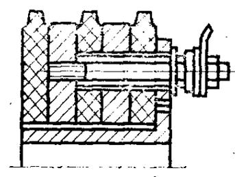
3.33. Узел контактных колец на пластмассе
