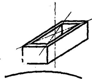
2.20. **Угол наклона оси обоймы щеткодержателя** — угол, образованный осью обоймы щеткодержателя и нормалью к поверхности коллектора или контактного кольца
