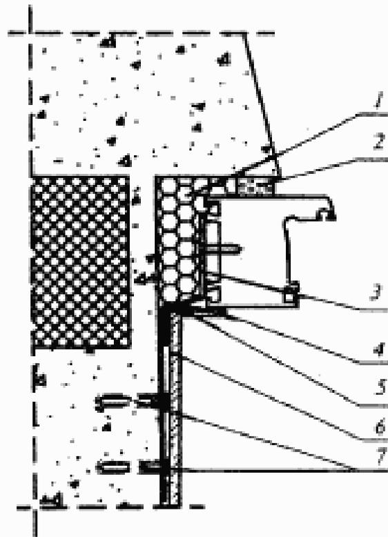
1 — пенный утеплитель; 2 — изоляционная саморасширяющаяся паропроницаемая лента; 3 — гибкая анкерная пластина; 4 — декоративный нащельник; 5 — пароизоляционная лента; 6 — элемент отделки внутреннего откоса; 7 — дюбель со стопорным шурупом
