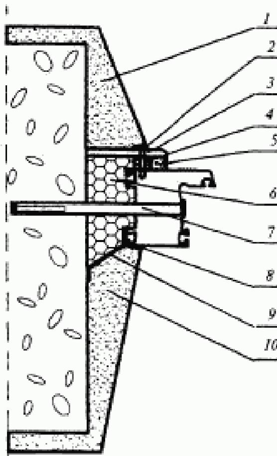
1 — штукатурный слой наружного откоса (с фаской для слоя герметика); 2, 8 — герметик; 3 — нащельник; 4 — дистанционная прокладка (шайба); 5 — изоляционная саморасширяющаяся паропроницаемая лента; 6 — пенный утеплитель; 7 — рамный добель; 9 — паронепроницаемая лента; 10 — штукатурный слой внутреннего откоса (с фаской для слоя герметика)
