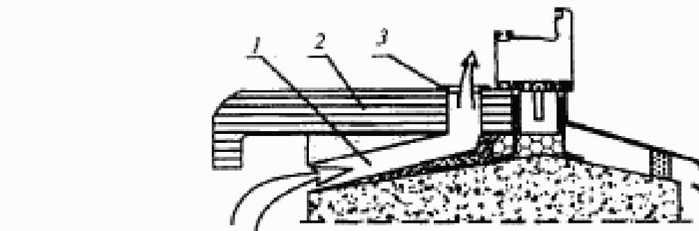
1 — канал подачи теплого воздуха от нагревательного прибора к оконному блоку (штроба в стяжке из штукатурного раствора); 2 — подоконная доска; 3 — декоративная решетка выходного отверстия
