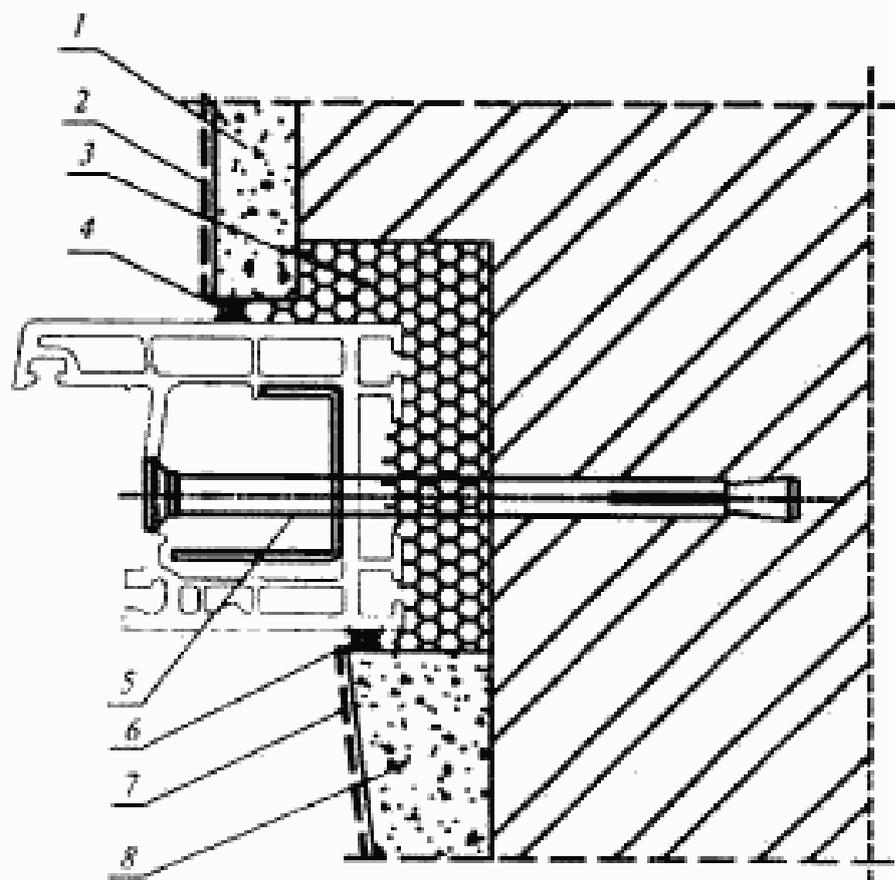
1 — отделка наружного откоса штукатурным раствором с коэффициентом паропроницаемости в соответствии с требованиями настоящего стандарта; 2 — паропроницаемая фасадная окраска; 3 — пенный утеплитель; 4, 6 — герметик; 5 — рамный дюбель; 7 — окрасочная пароизоляция; 8 — слой штукатурного раствора с высоким коэффициентом сопротивления паропроницанию
