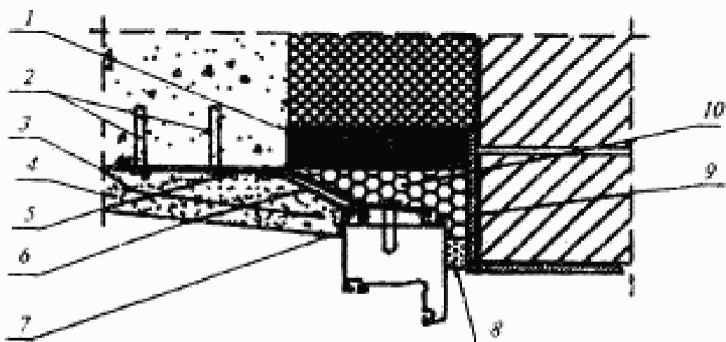
1 — вкладыш из антисептированного пиломатериала; 2 — дюбель со стопорным шурупом; 3 — армирующая сетка; 4 — штукатурный слой внутреннего откоса (с фаской для слоя герметика), возможна отделка листовым материалом ( влагостойкая панель); 5 — гибкая анкерная пластина; 6 — паронепроницаемая лента; 7 — герметик; 8 — изоляционная саморасширяющаяся паронепроницаемая лента; 9 — стальная перемычка с антикоррозионным покрытием; 10 — пенный утеплитель
