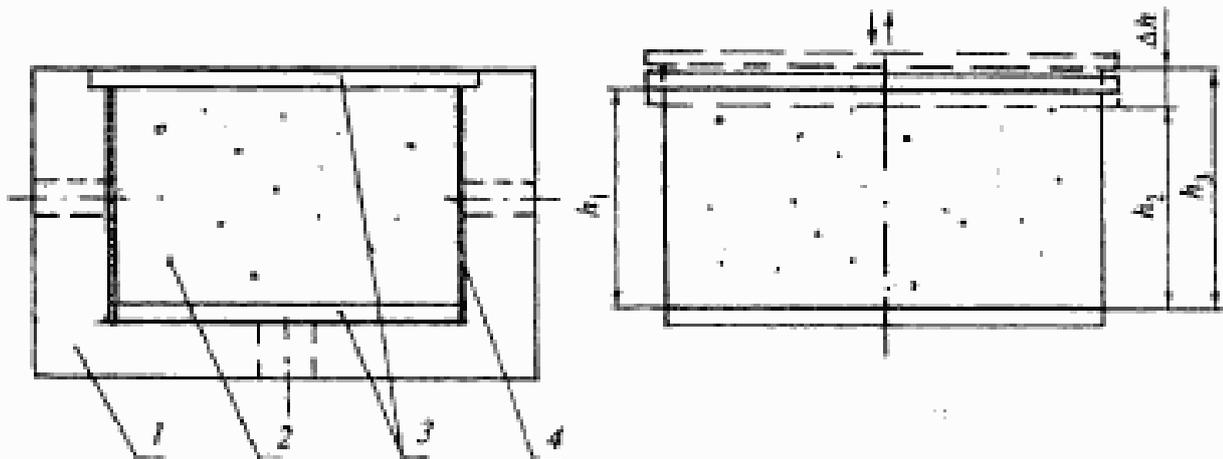
I — положение пластин при заданной (начальной) толщине образца ( $h_1$ );
