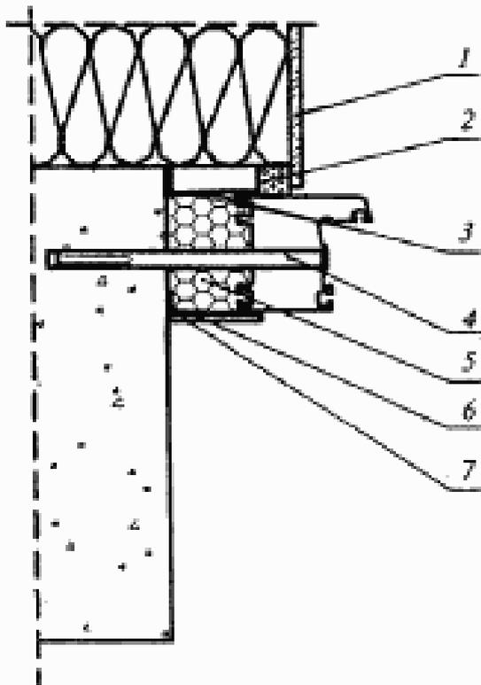
1 — элемент отделки наружного оконного откоса; 2 — изоляционная саморасширяющаяся паропроницаемая лента; 3 — волокнистая паропроницаемая лента; 4 — рамный дюбель; 5 — пенный утеплитель; 6 — пароизоляционная лента; 7 — декоративный нащельник
