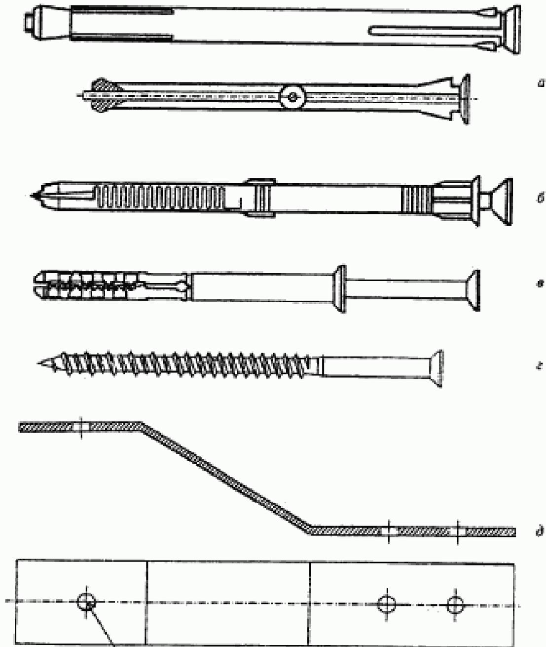
*a* — металлический рамный дюбель; *b* — пластмассовый рамный дюбель; *в* — универсальный пластмассовый дюбель со стопорным шурупом; *г* — строительные шурупы; *д* — гибкая анкерная пластина
