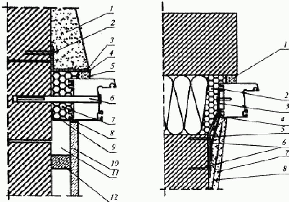
1 — штукатурный слой наружного откоса (с фаской для слоя герметика); 2 — строительный шуруп; 3 — герметик; 4 — фальшчетверть из уголка; 5 — изоляционная саморасширяющаяся паропроницаемая лента; 6 — рамный дюбель; 7 — пенный утеплитель; 8 — герметик; 9 — пароизоляционная лента; 10 — элемент отделки внутреннего откоса; 11 — полость, которая может быть заполнена теплоизоляционным материалом; 12 — рейка
