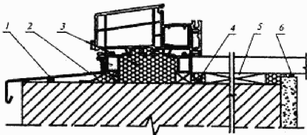
1 — шумопоглощающая прокладка; 2 — водонепроницаемая паропроницаемая лента; 3 — пенный утеплитель; 4 — парозащитная лента; 5 — несущая опорная колодка; 6 — герметик
