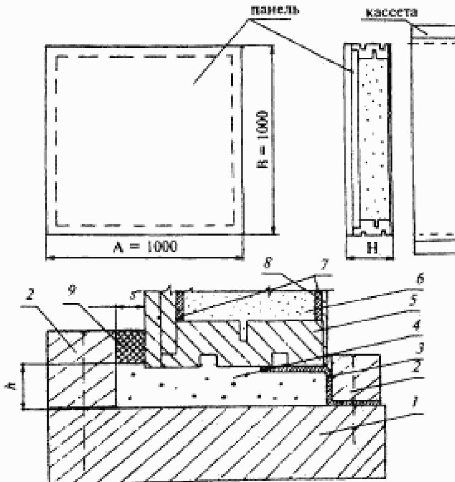
А, В, Н — размеры панели  $\lambda$ ,  $h$  — размеры зазоров под монтажный шов; 1 — кассета с накладными брусками; 2 — накладные бруски; 3 — паронепроницаемая лента; 4 — пенный утеплитель; 5 — коробка панели; 6 — заполнение панели (например, звукоизоляционный материал); 7 — звукопоглощающая прокладка; 8 — обшивка панели; 9 — водонепроницаемая прокладка
