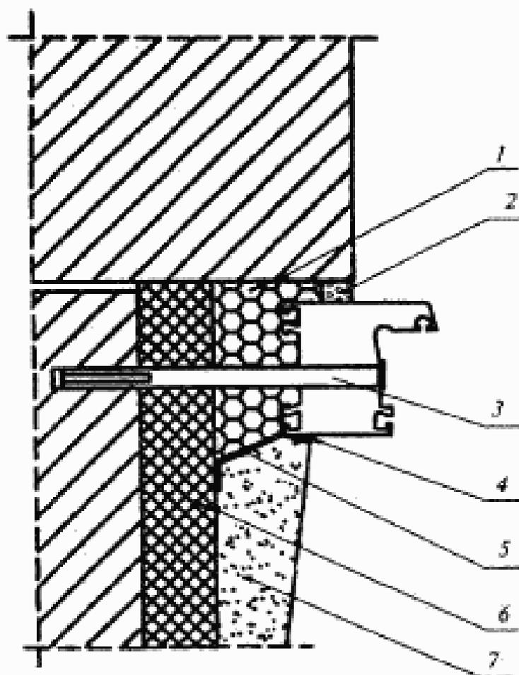
1 — пенный утеплитель; 2 — изоляционная саморасширяющаяся паропроницаемая лента; 3 — рамный дюбель; 4 — герметик; 5 — паронепроницаемая лента; 6 — компенсатор монтажного зазора (может применяться для утепления откоса и изоляции пенного утеплителя от плоскости возможной конденсации); 7 — штукатурный слой внутреннего откоса (с фаской для слоя герметика)
