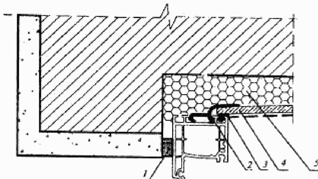
1 — изоляционная саморасширяющаяся паропроницаемая лента; 2 — дополнительный профиль; 3 — герметик; 4 — влагостойкий гипсокартон с парозащитным покрытием; 5 — пенный утеплитель
