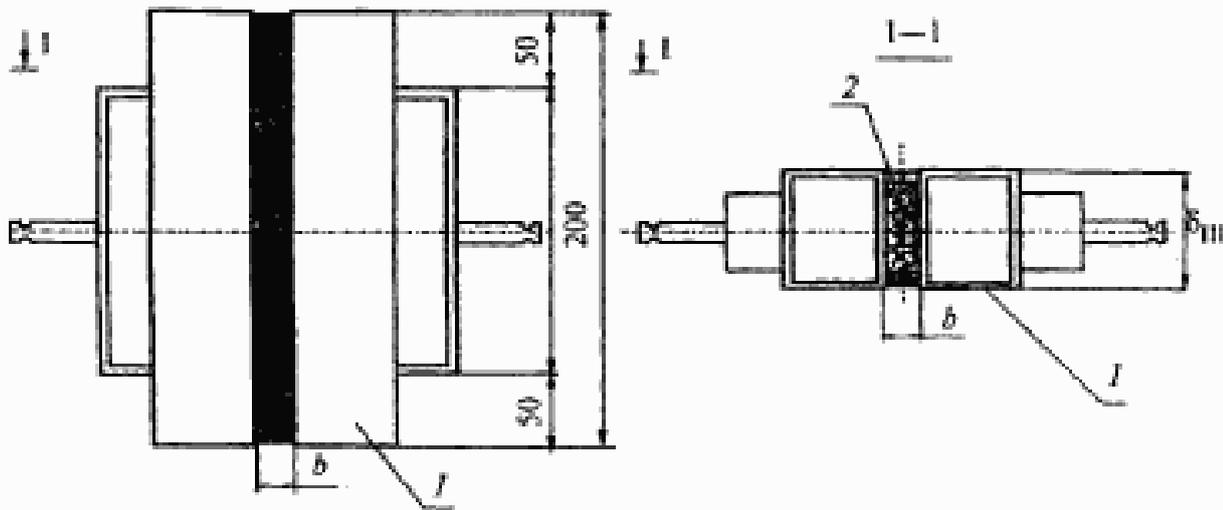
$b$  — толщина шва;  $1$  — обойма из алюминия или нержавеющей стали толщиной 3 мм;
