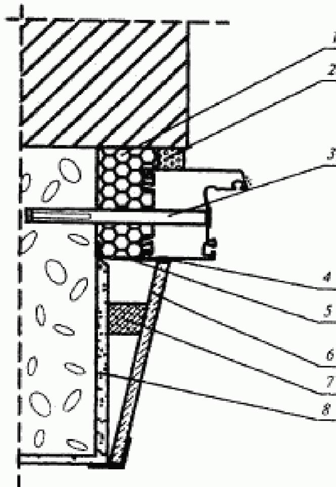
1 — пенный утеплитель; 2 — изоляционная саморасширяющаяся паропроницаемая лента; 3 — рамный дюбель; 4 — герметик; 5 — паронепроницаемая лента; 6 — панель отделки внутреннего откоса; 7 — рейка; 8 — штукатурный выравнивающий слой внутреннего откоса
