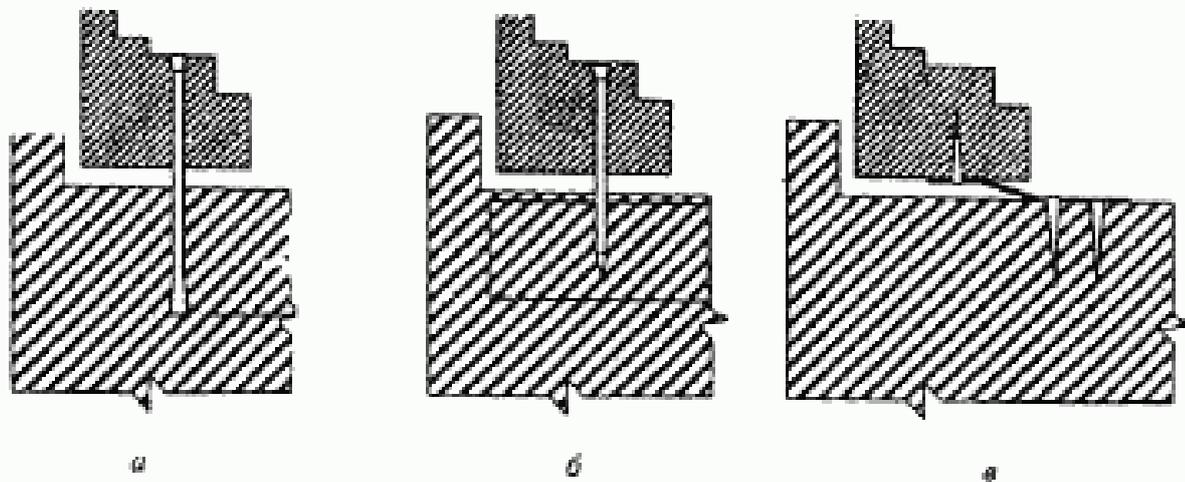
*a* — крепление распорными равными дюбелями; *b* — крепление строительными шурупами, *v* — крепление при помощи гибких анкерных пластин
