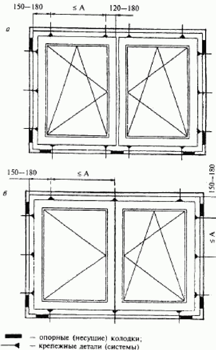
*a* — оконный блок с вертикальным импостом; *b* — оконный блок с безимпостным (штульповым) притвором; *A* — расстояние между крепежными деталями
