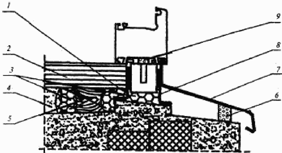
1 — пароизоляционная лента; 2 — подоконная доска; 3 — пенный утеплитель; 4 — штукатурный раствор; 5 — опорная колодка подоконной доски; 6 — шумогасящая прокладка; 7 — слив; 8 — водонепроницаемая паропроницаемая лента; 9 — изоляционная саморасширяющаяся паропроницаемая лента
