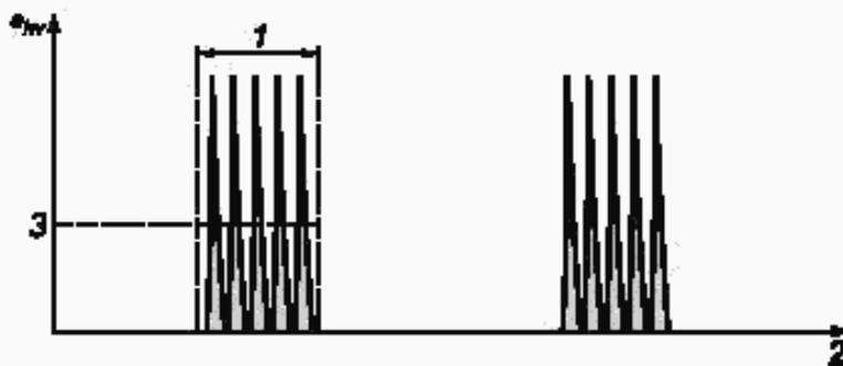
1 — длительность измерений; 2 — время; 3 —  $a_{hv, \text{фиксированная}}$
