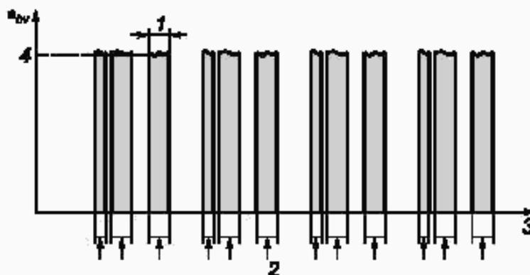
1 — длительность измерений; 2 — время воздействия вибрации (в данном случае, общее время работы инструмента); 3 — время; 4 —  $a_{hv, макс}$
