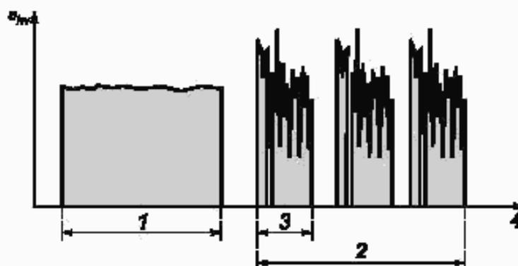
1 — инструмент 1; 2 — инструмент 2; 3 — рабочий цикл; 4 — время
