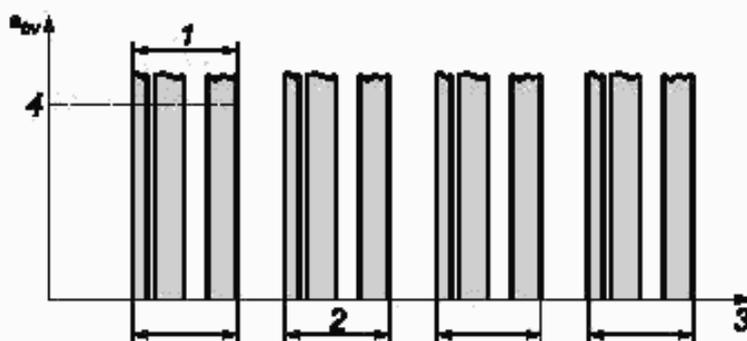
1 — длительность измерений; 2 — время воздействия вибрации (в данном случае, общее время использования инструмента); 3 — время; 4 —  $a_{nv, \text{max/med}}$
