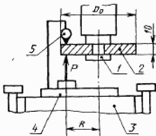
$D_0$  — диаметр опорного диска;  $R$  — радиус нагружения
