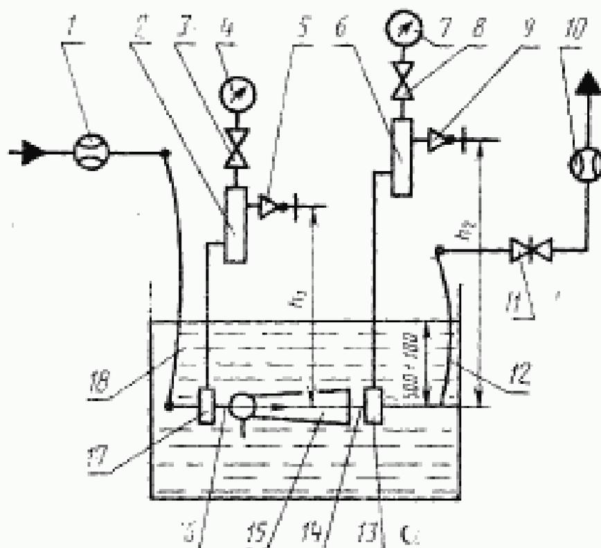
1, 10 — расходомер; 2, 6 — демферное устройство; 3, 8 — кран; 4 — манометр 1,6 МПа (16 кгс/см<sup>2</sup>); 5, 9 — кран; 7 — манометр 0,1 МПа (1 кгс/см<sup>2</sup>); 11 — задвижка D<sub>y</sub> — 80; 12, 18 — пожарный рукав; 13, 17 — уравнительная камера; 14, 16 — мерный участок трубопровода; 15 — эжектор
