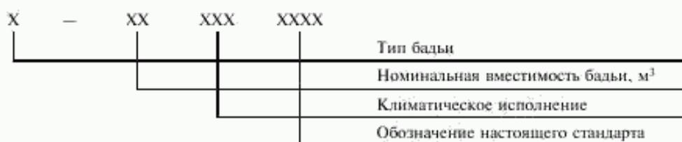
Пример условного обозначения бады проходческой для механизированной разгрузки, номинальной вместимостью 4,5 м<sup>3</sup>, для климатического исполнения У:
