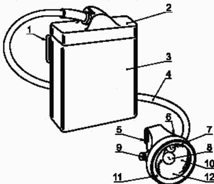
1 — ушко для ремня; 2 — защитная крышка; 3 — корпус батареи; 4 — кабели; 5 — клипса на каску; 6 — фара; 7 — дополнительный источник света; 8 — основной источник света; 9 — кнопка выключателя; 10 — рефлектор; 11 — обрамляющее кольцо; 12 — стекло (защитный светопропускающий элемент)
