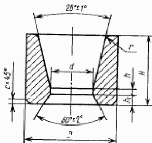
Примечание. По заказу потребителя допускается изготовление волок-заготовок с каналами радиального профиля, при этом размеры  $D$ ,  $d$ ,  $H$  берут по табл. 1, а остальные размеры устанавливаются по соглашению потребителя и изготовителя.
