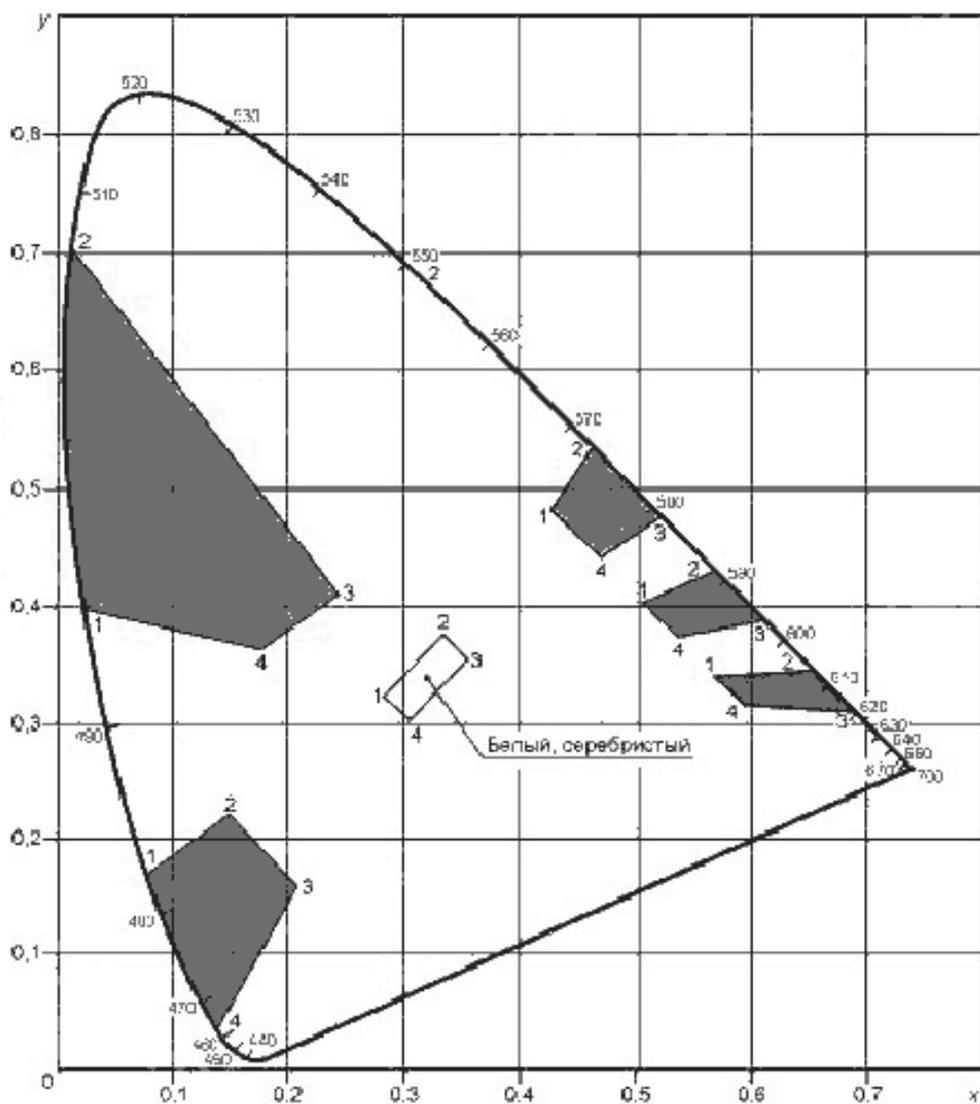
Рисунок 1 — График цветных областей для знаков со светоотражающей поверхностью
